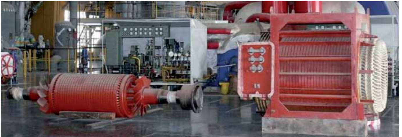
Rotor y estator
