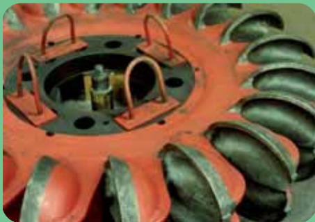
Fotografia i esquema 2.3. Funcionament d'una turbina Pelton
