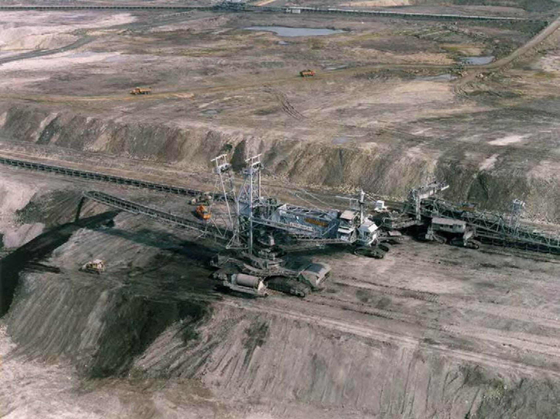
Apiladora apilando en profundidad, 1997
