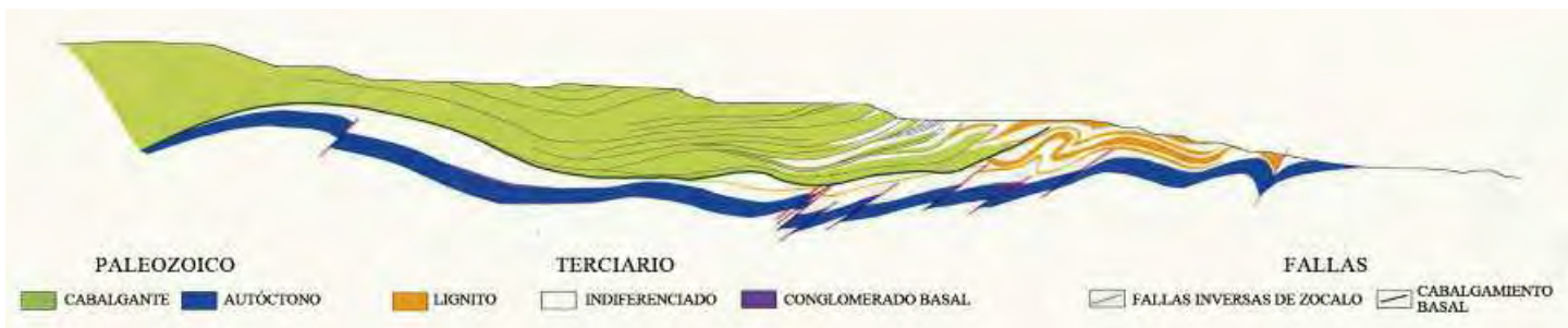
Fig. 4. Corte longitudinal mostrando el cabalgamiento basal sobre el terciario en el borde norte del yacimiento
