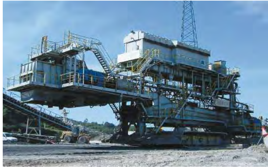
Transporte de una cabeza Krupp 2.200 por carro portacabezas
