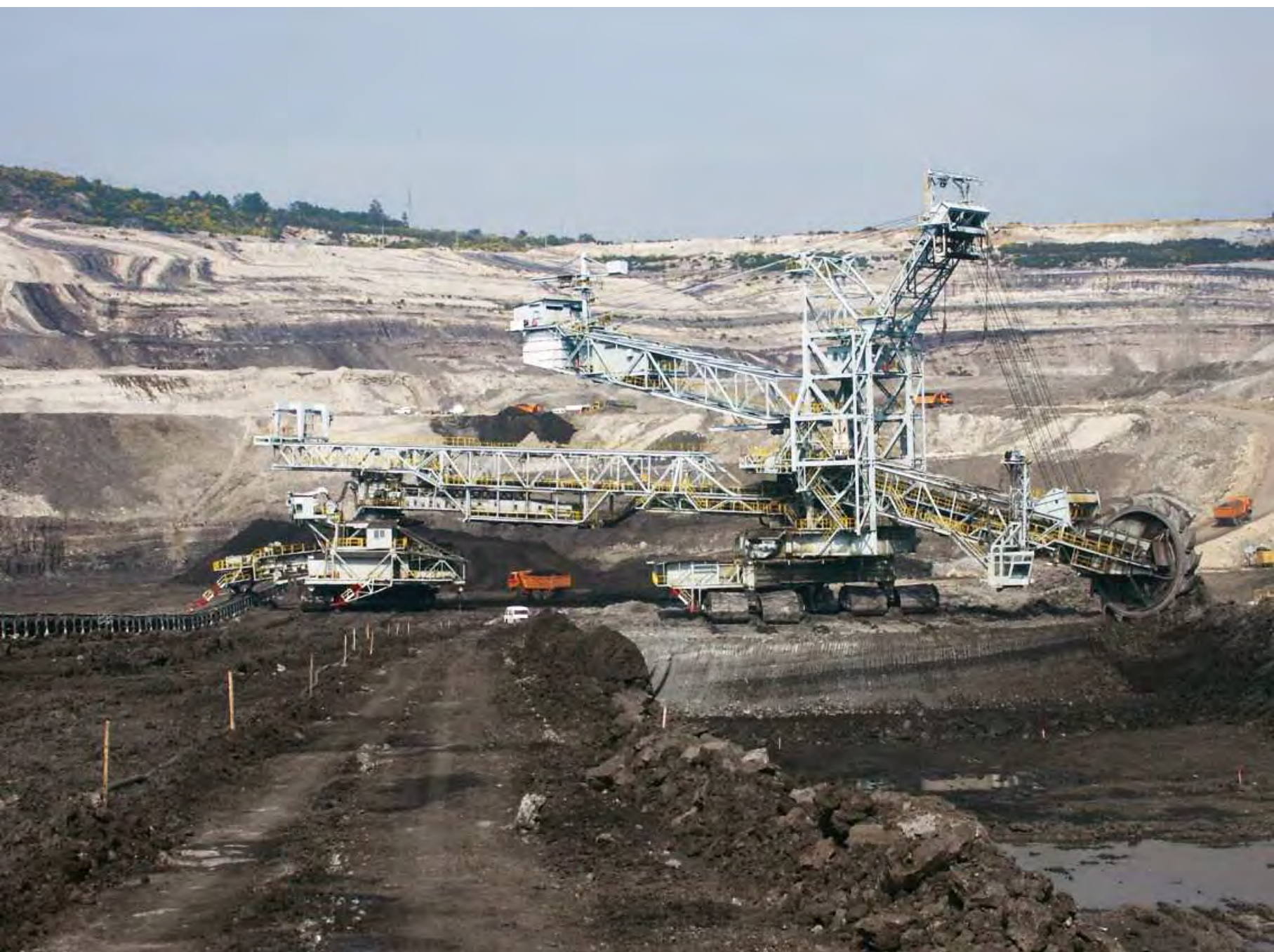
Excavadora 12 ejecutando una pasada en profundidad, 2003
