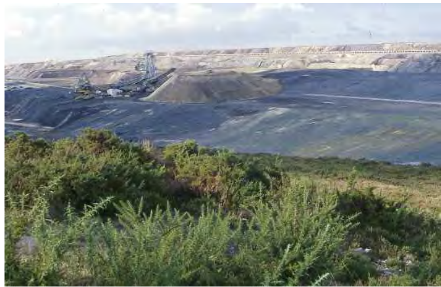
Las pizarras del umbral fueron el material alternativo a la tierra vegetal. Rotopala excavando y apiladora acopiando el material, 1992
