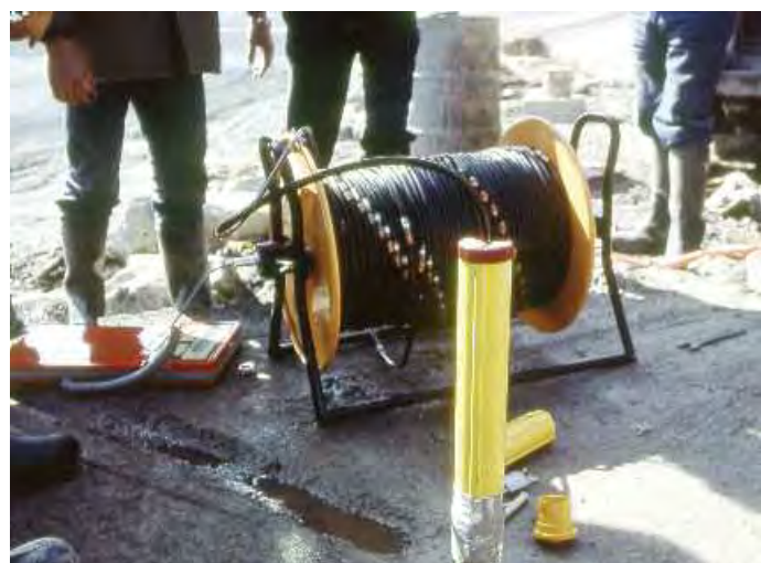
Medida manual de un inclinómetro
