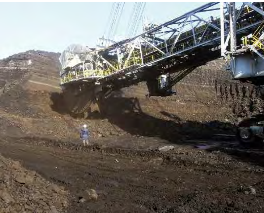
Excavadora 16 en un banco de carbón, detalle del rodete
