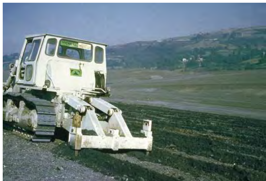
Ripados y subsolados son operaciones adecuadas para descompactar el suelo, 1990
