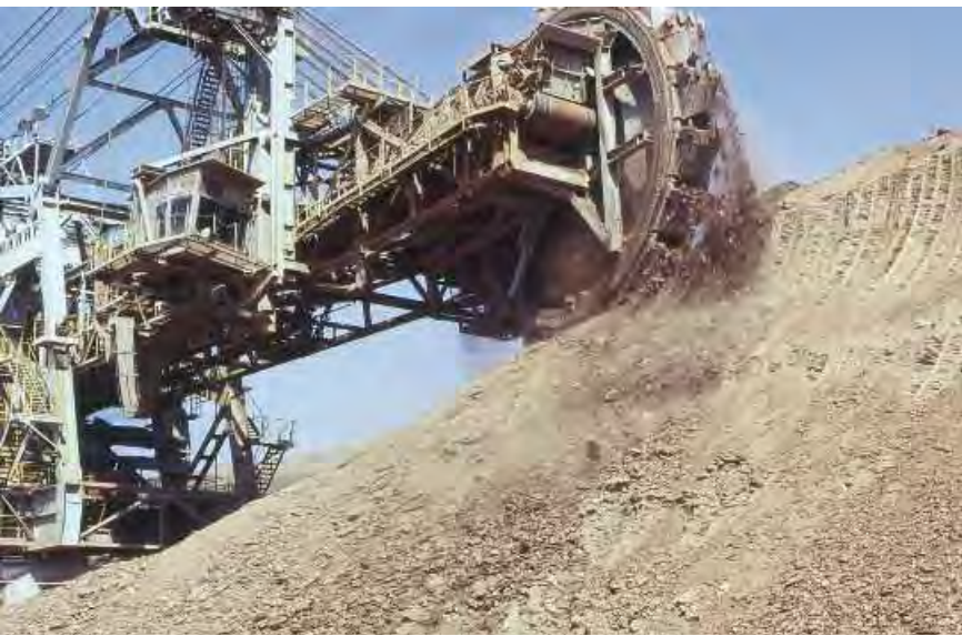
Las pizarras del umbral fueron el material alternativo a la tierra vegetal. Rotopala excavando y apiladora acopiando el material, 1992
