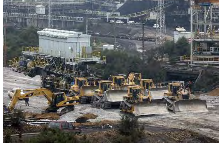
Traslado de apiladoras desde la escombrera exterior al campo este de la mina
