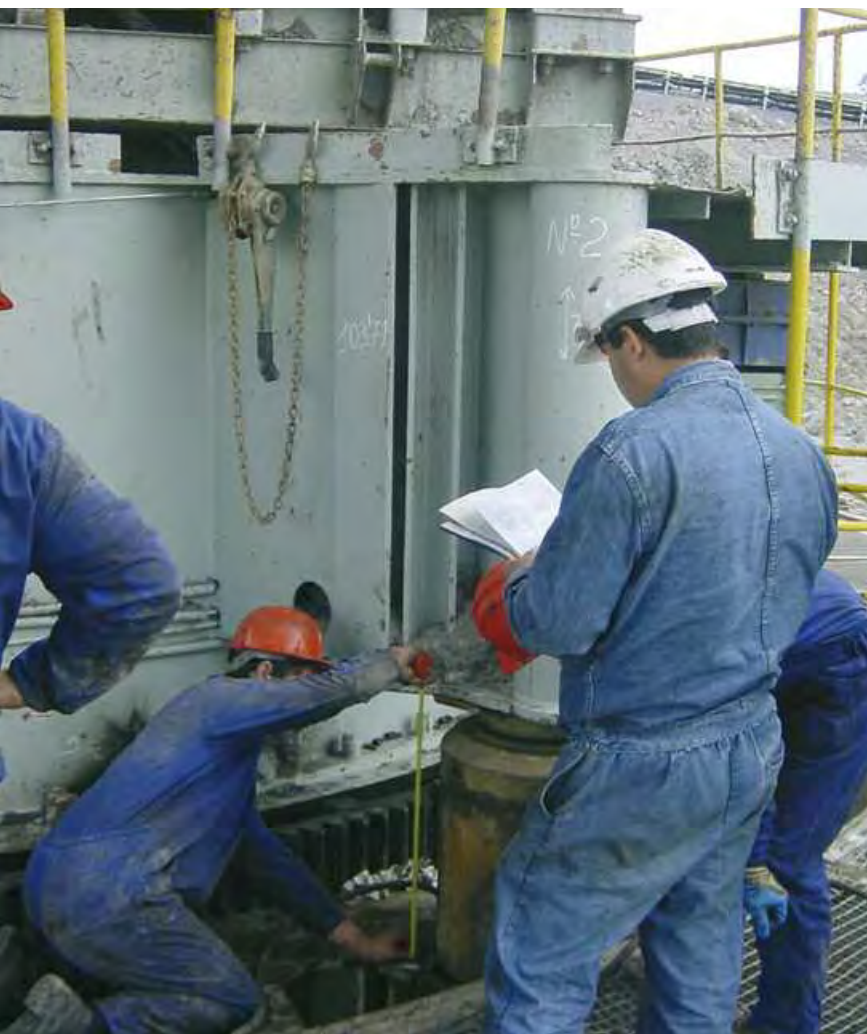
Actuaciones en reductora de rodete de una excavadora Takraf
