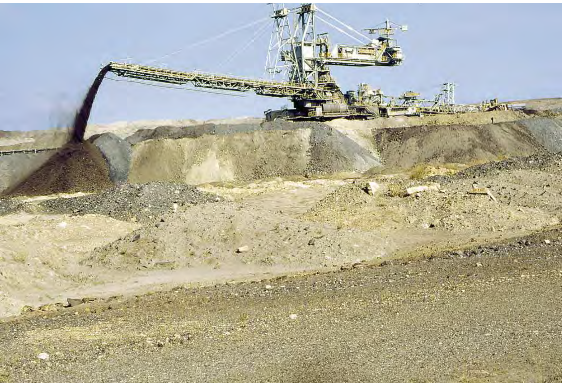
Apiladora en escombrera exterior
