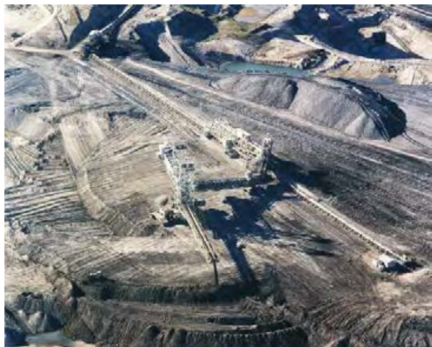
Escombrera interior intermedia. A-29 vertiendo detrás del dique de pizarra
