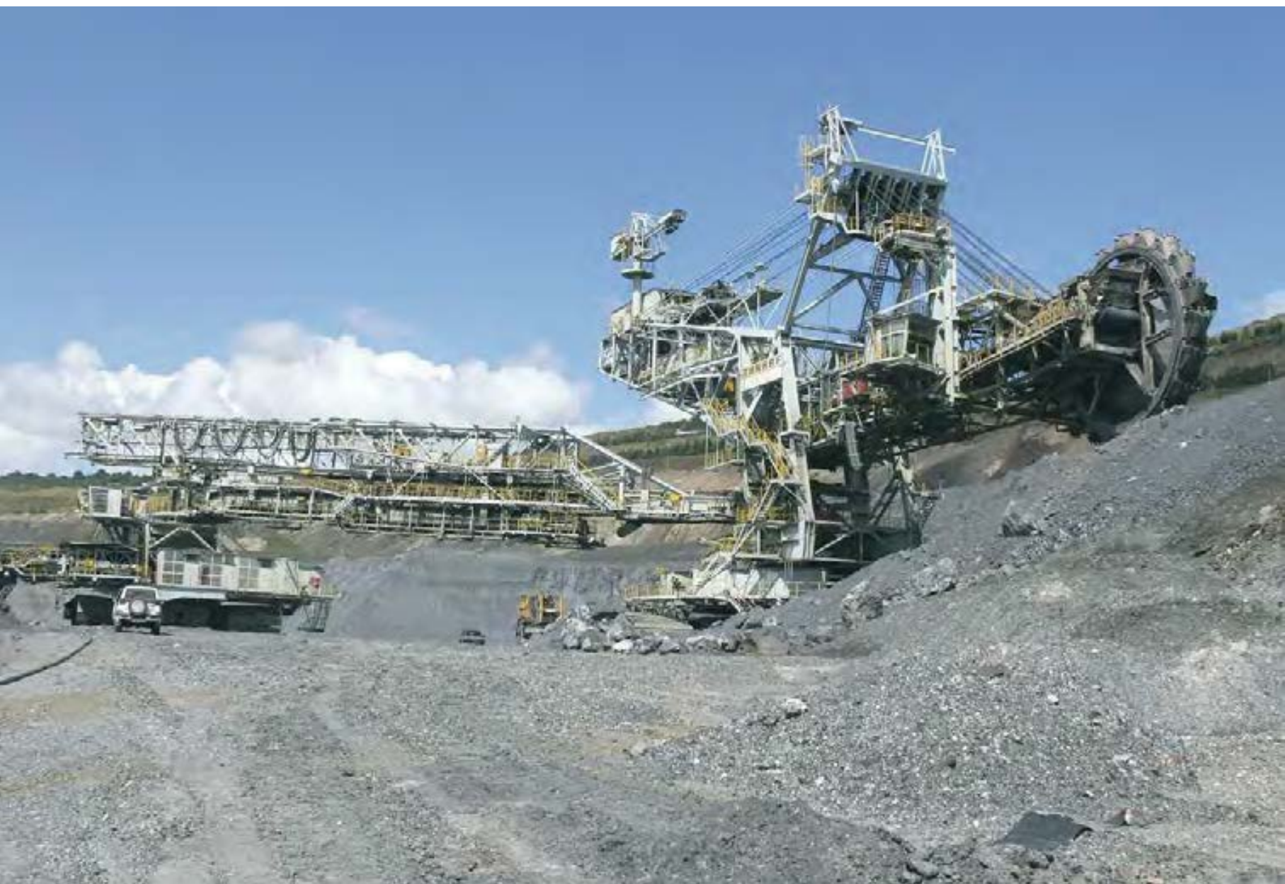
Excavación de pizarras en el talud norte con excavadora de rodete
