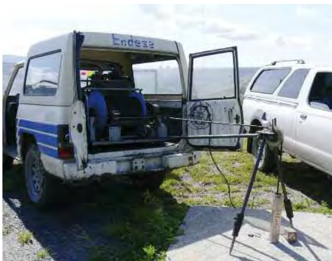
Medida automatizada de un inclinómetro
