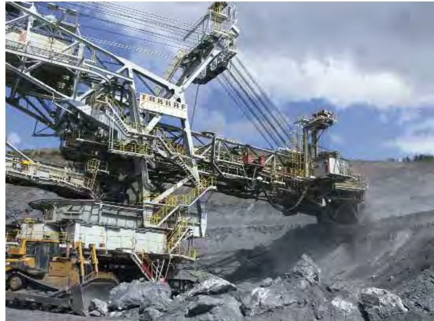
Excavación de pizarras en el talud norte con excavadora de rodete
