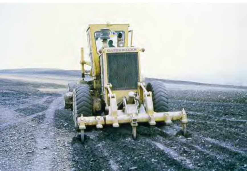
Ripados y subsolados son operaciones adecuadas para descompactar el suelo, 1990
