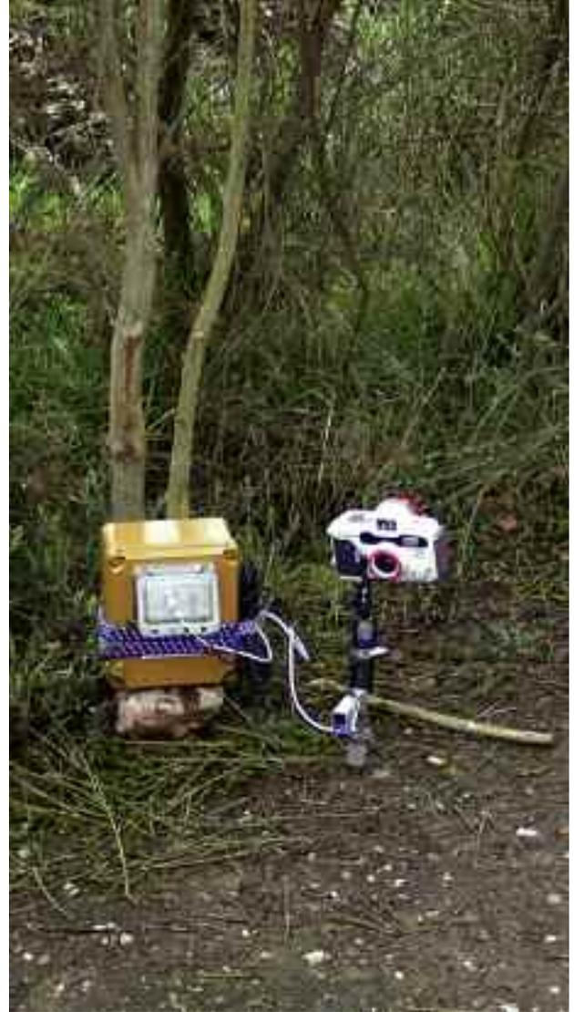
Un equipo de fotografía pasiva preparado para tomar fotos de pequeños carnívoros. El sensor está instalado debajo de la cámara. La caja contiene la batería y los mecanismos de sincronización del sensor con la cámara
